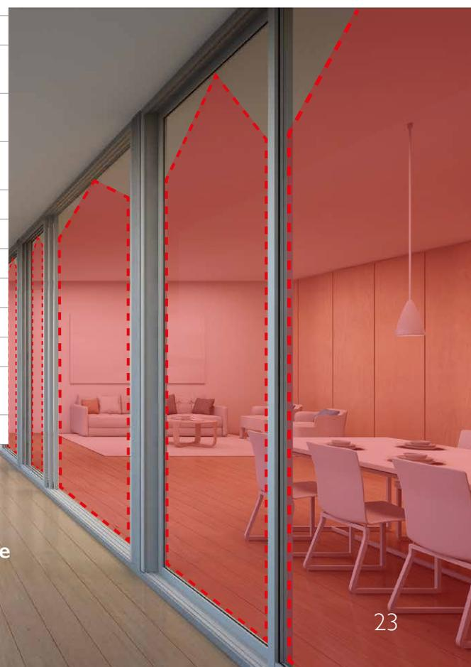
Sensori in grado di creare una barriera di protezione "a tenda" utile per porte e finestre.
